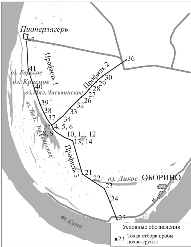
Рис. 4.8. Схема опробования почвогрунтов в районе открытого стенда
