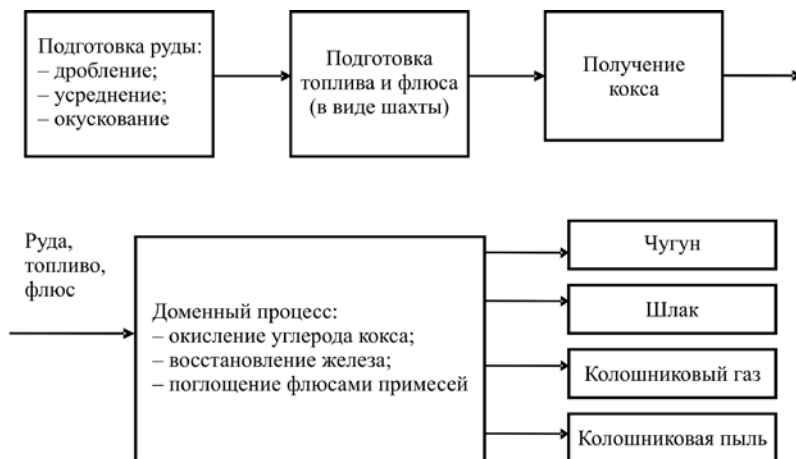
Рис. 2.1. Схема процесса получения чугуна
