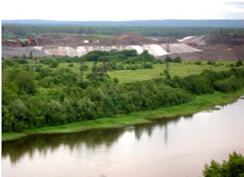
Рис. 5.2. Открытый способ складирования шлаков на берегу реки
